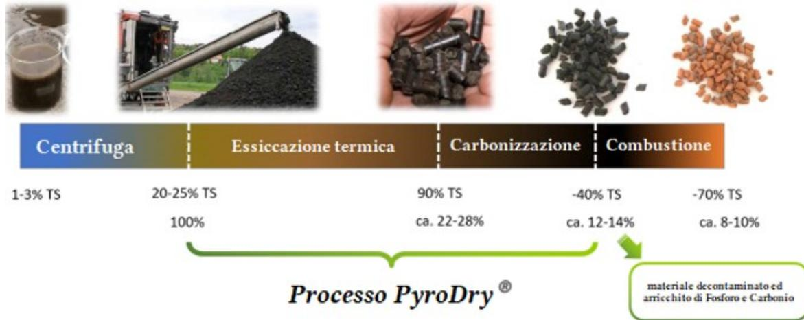
Figura6: Riduzione di massa dei fanghi di depurazione attraverso il Processo-PYRODRY®
